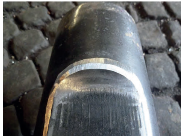
nach dem Entgraten kann der Meißel wieder in die Meißelbuchse eingeschoben werden. (Meißelpaste!)
