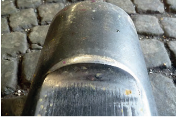
von der Sperrachse / Haltekeil aufgestauchter Bord (Haltenut), muss entgratet werden!
